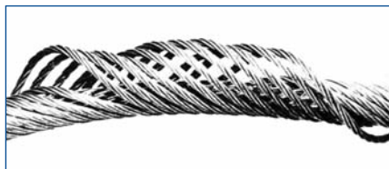
Дефект «птичья клетка» в многослойном (малокрутящемся) канате, вызванный усиленным вращением вокруг небольших канавок или слишком большим углом девиации. Требуется срочная замена каната.
