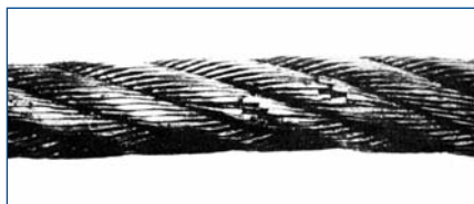
Обрывы проволоки в двух прядях вследствие усталости при изгибе и серьезного локализованного износа. Канат подлежит замене
