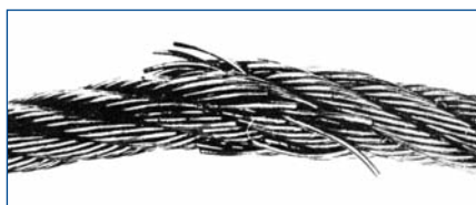
Обрывы проволоки в нескольких прядях, расположенных близко к холостому шкиву (иногда затягиваются шкивом). Канат подлежит замене.
