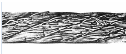
Сильный износ и большое количество обрывов проволоки в канате крестовой свивки. Требуется срочная замена каната.
