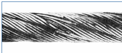
Обрывы проволоки в одной пряди и слабый износ каната параллельной свивки. Необходимо удалить обрывы проволоки, придать канату гладкость.
