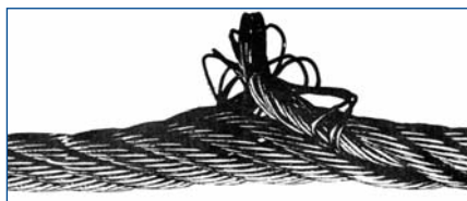
Выступ стального сердечника, вызванный, как правило, деформацией типа «фонарь». Требуется срочная замена каната.
